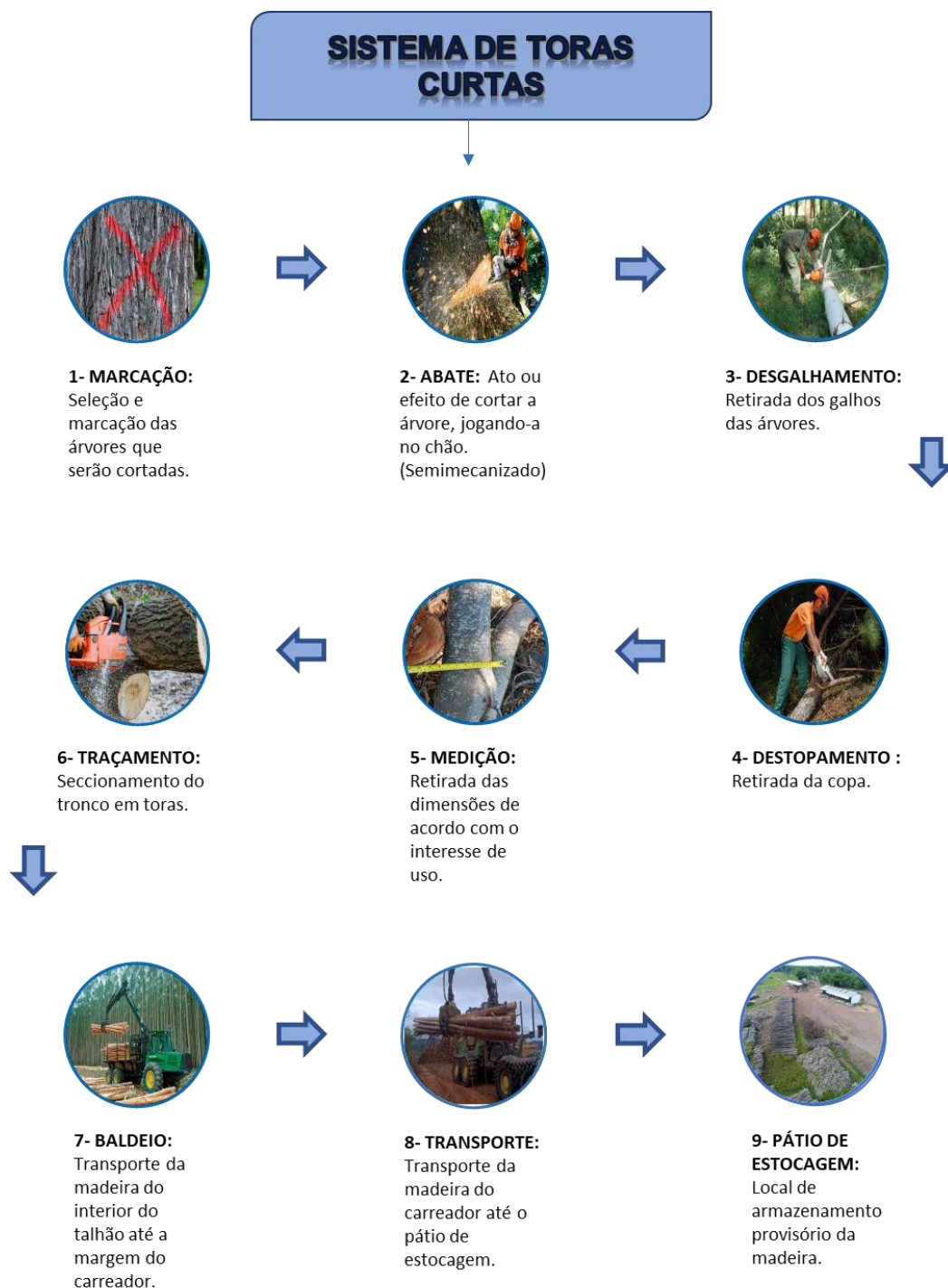
Figura 15. Fluxograma da colheita florestal utilizando o sistema de toras curtas, em povoamentos de teca nas UMFs da empresa Tietê Agrícola Ltda (imagens ilustrativas).
