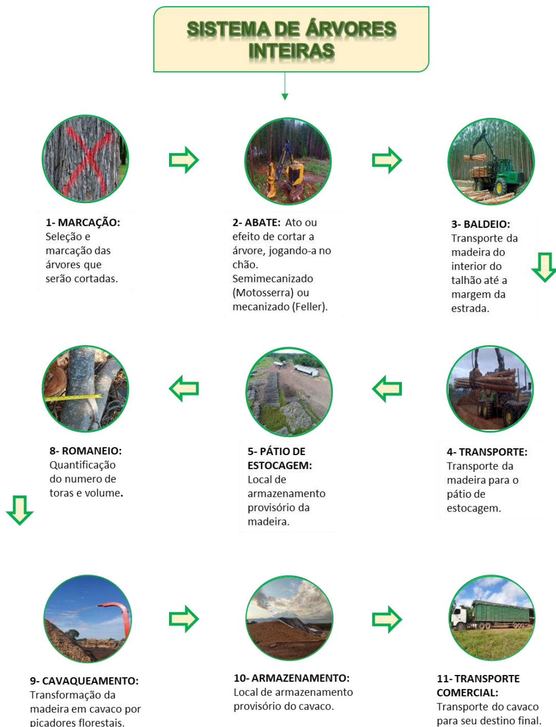
Figura 19. Fluxograma da colheita florestal utilizando o sistema de árvores inteiras, em povoamentos de teca nas UMFs da empresa Tietê Agrícola Ltda (imagens ilustrativas).
