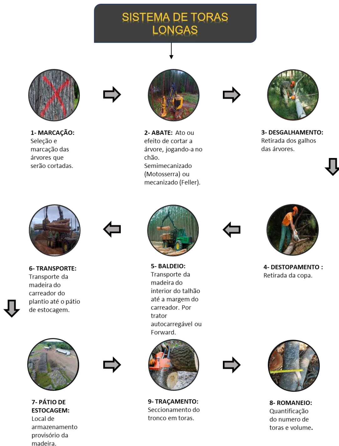
Figura 17. Fluxograma da colheita florestal utilizando o sistema de toras longas, em povoamentos de teca nas UMFs da empresa Tietê Agrícola Ltda (imagens ilustrativas).
